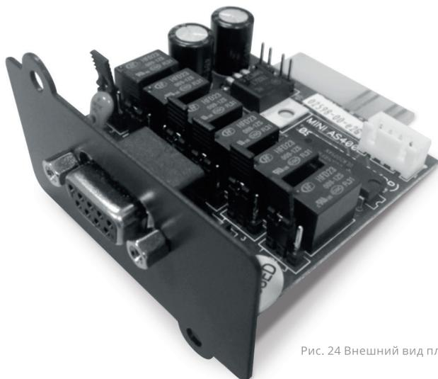
Рис. 24 Внешний вид платы реле
