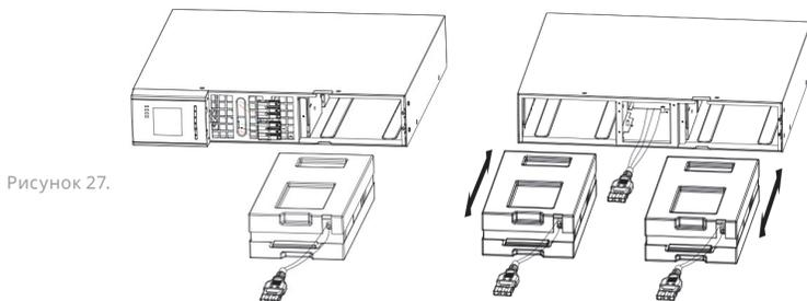
4. Возьмите новый комплект аккумуляторных батарей за его среднюю часть и вставьте его в отсек ИБП или ВБМ. После установки нового комплекта аккумуляторных батарей необходимо убедиться в том, что он полностью попал на полозья шасси, как это показано на рисунке 28.
