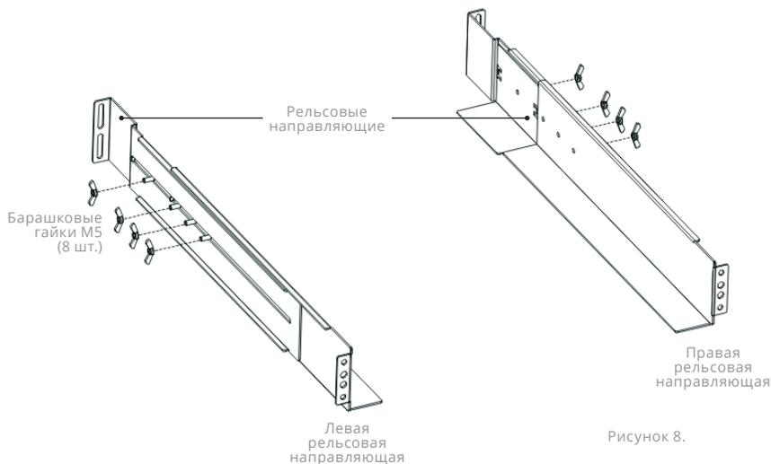
2. Выберите подходящие размеры в стойке для размещения ИБП. Рельсовые направляющие крепятся в четырех местах на передней и задней частях стойки.
