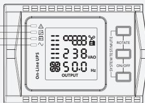
Рисунок 5. Панель управления ИБП
